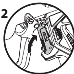
Pistola destravada (a pistola pulverizará)
