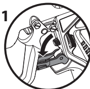
Gatillo bloqueado (la pistola no pulveriza)
