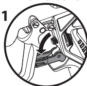
Abzug verriegelt (Spritzpistole sprüht nicht)
